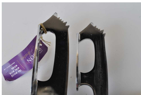
Kuva 4: Vasemmalla uusi terä (Pattern 99), oikealla virheellisen teroituksen aiheuttama kuoppa profiilissa. Vasen terä on kooltaan suurempi, mutta muodon tulisi olla sama molemmissa.
